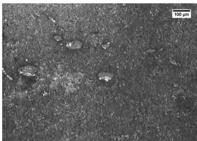
10. Liczne wtrącenia żużla w miejscu B na powierzchni płazu głowni (fot. J. Stepiński)
