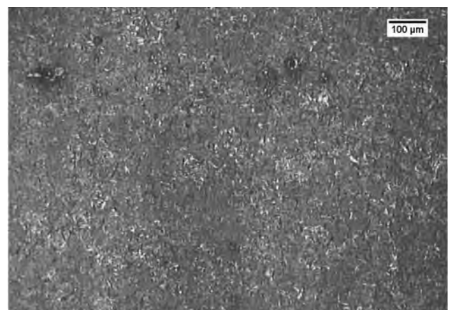
6. Fragment mikrostruktury pasma ferrytu o zróżnicowanej wielkości ziarna, w obszarze niskowęglowym, w miejscu A na powierzchni płazu głowni Szczerbca (fot. J. Stępiński)
