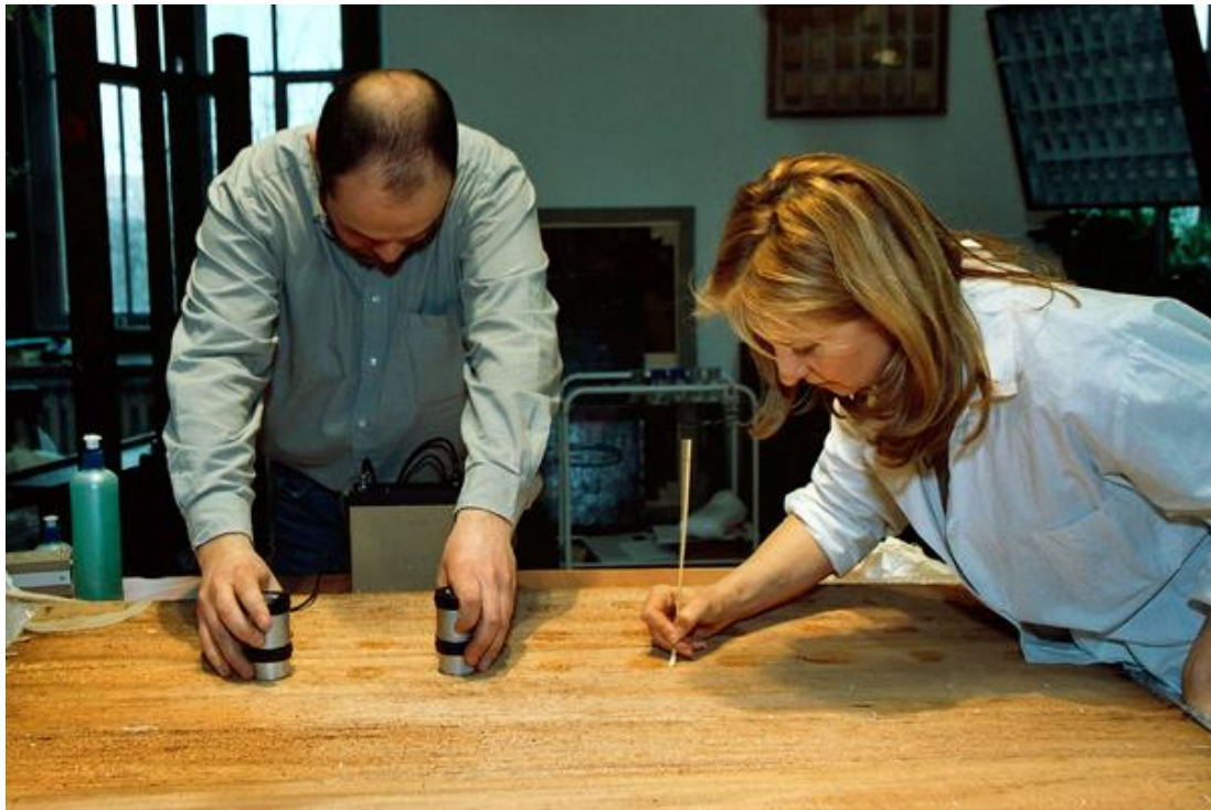
Fot. 3. Fragment odwrócenia obrazu w trakcie badania ultradźwiękami.
